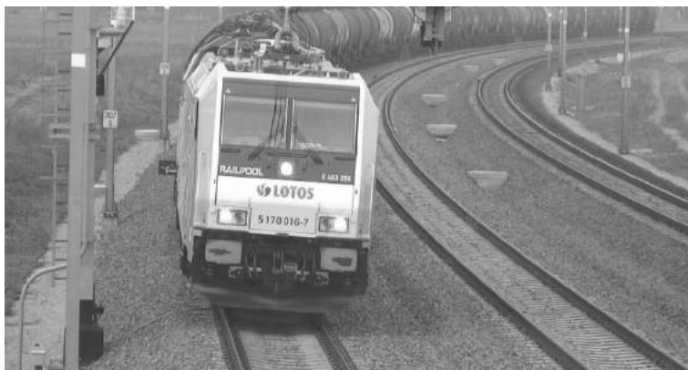
Widok lokomotywy TRAXX o mocy 5,6 MW na nowo przebudowanej linii nr 009 (fotografia wykonana przez kamerę stanowiska monitoringu odbieraków prądu)
