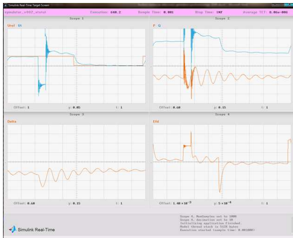
Rys. 8. Przebiegi symulacji generatora synchronicznego w środowisku Simulink RealTime
